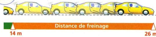
La distance de freinage dépend de la vitesse du véhicule et d'autres paramètres : conditions climatiques, état des pneumatiques, état de la route (sèche ou mouillée), état des freins, etc.
